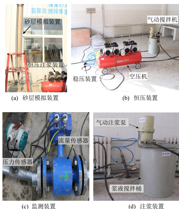
图2 注浆系统试验装置图 Fig.2 Photos of grouting experiment system
